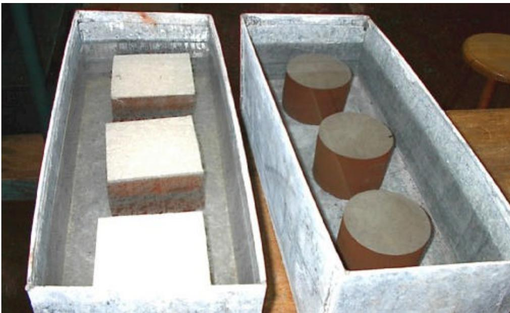
**Figura 4** - Corpos de prova imersos em água.
