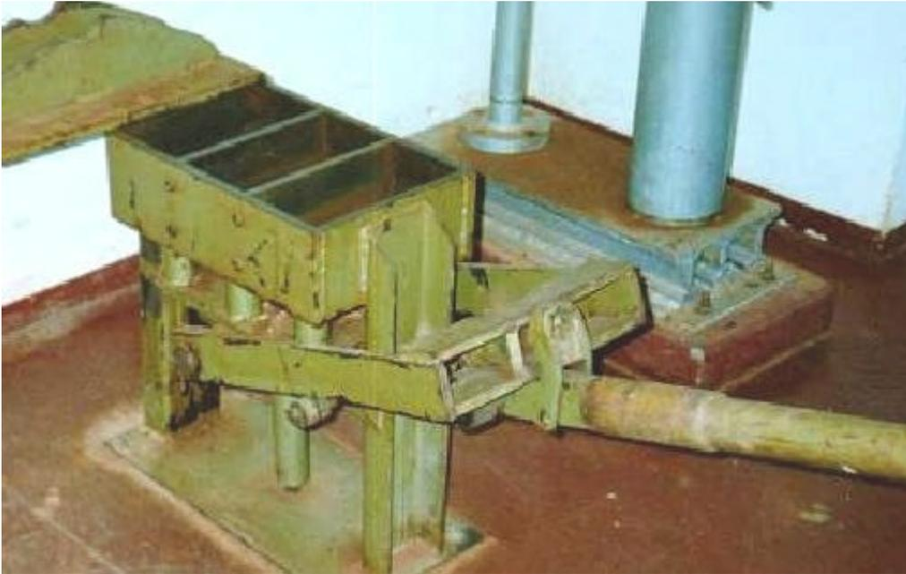
**Figura 3** - Prensa utilizada na moldagem dos tijolos.
